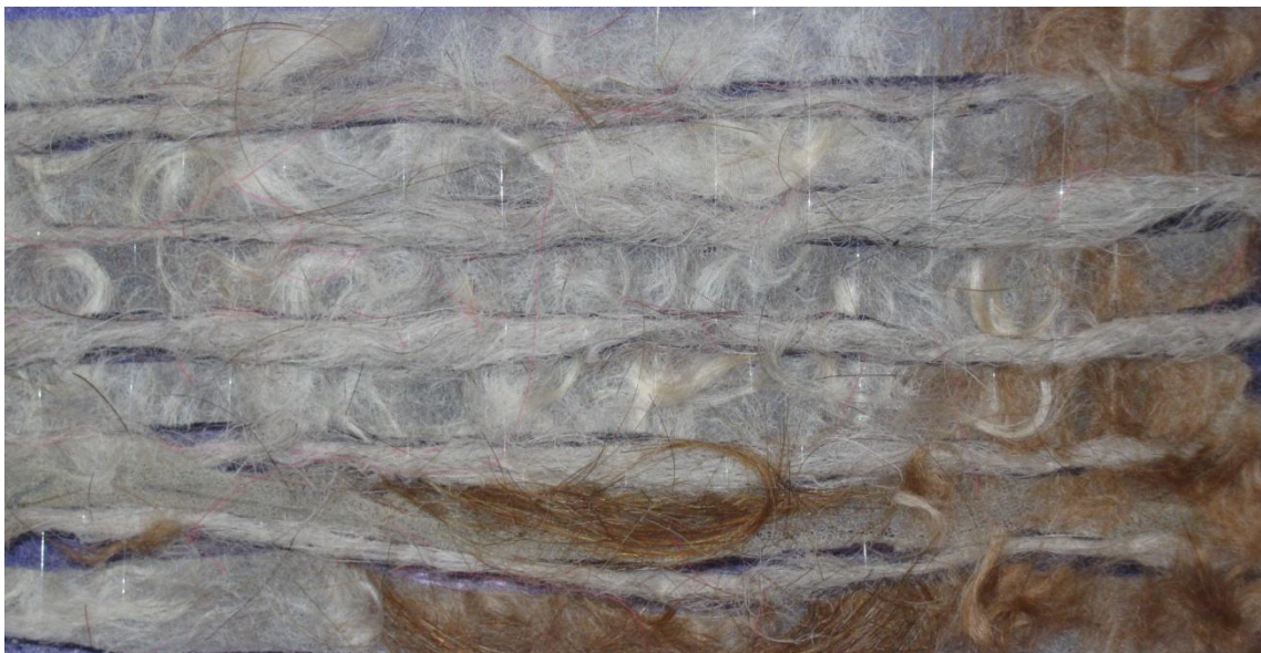
Figura 2- Experimentação de tecimento com pelo animal de coloração natural aplicado sobre microfibra com silicone.
