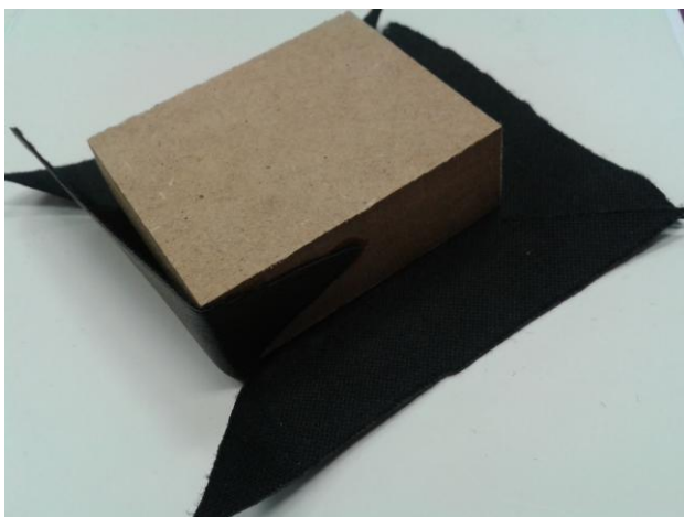
Figura 04: colagem das quinas da peça de MDF
