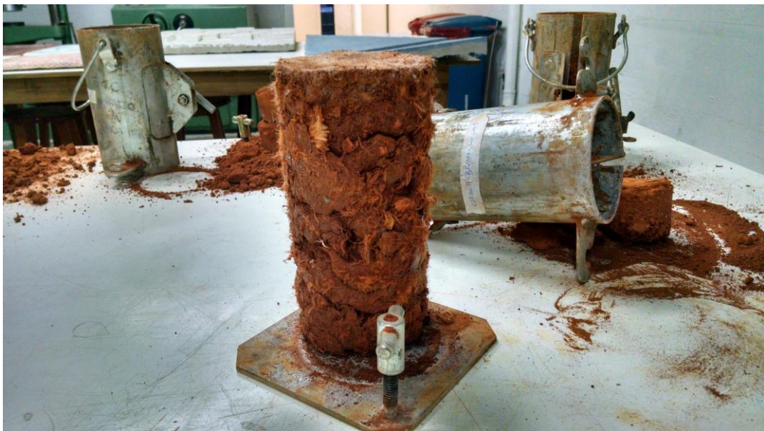
Imagem 11: corpo de prova de terra, baba de cupim e fibra de polipropileno.
