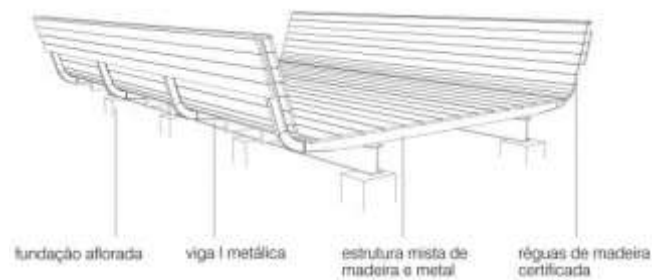
Figura 6– Perspectiva Axonométrica do Deck
