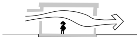
Figura 14 - Ventilação cruzada - varanda. (FONTE: Lengen, 2004, citado por Silva, 2006).
