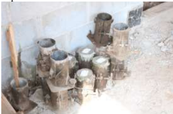
Figura 10: Corpos de Prova para verificar a qualidade do concreto.
