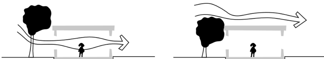
Figura 9 - Ventilação natural com presença de vegetação. Na presença de vegetação alta a brisa desce e refresca (à esquerda) e na presença de vegetação baixa a brisa sobe e não refresca (à direita)
