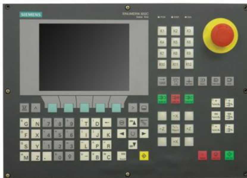
Figura 4 – Painel de Controle Numérico do Torno CNC TCA-360
