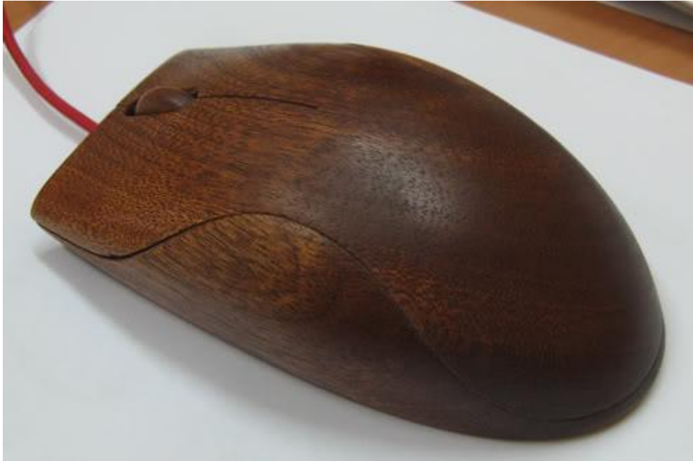
Figura 9 – Mouse de Madeira feito com Fresadora CNC
