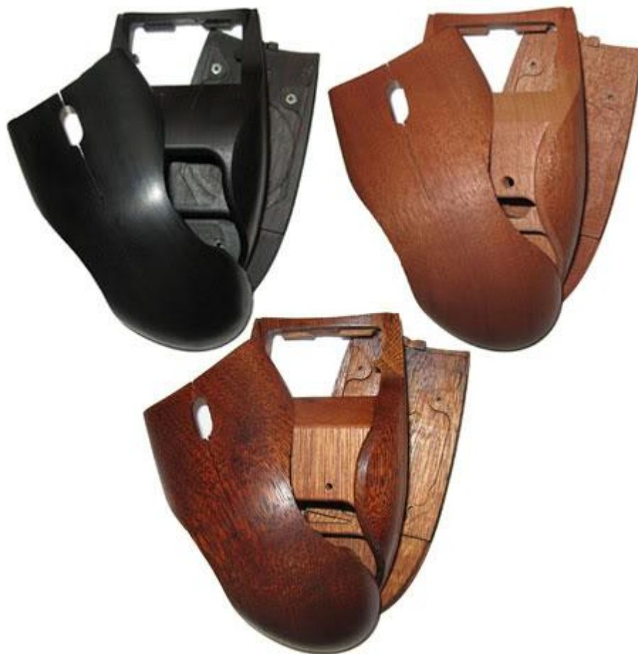
Figura 10 – Peças do Mouse produzido através da Frezadora CNC
