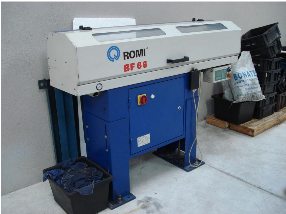
Figura 11 – Aparelho Alimentador de Barras BF-66
