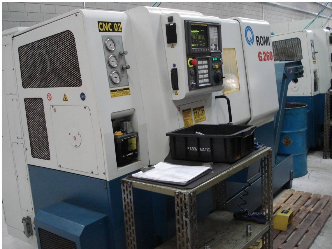
Figura 16 – Torno G260 com Sistema CNC
