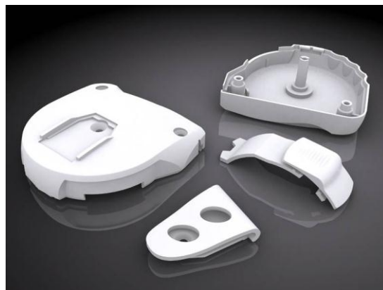
Figura 12: Peças produzidas pelo processo de prototipagem rápida utilizando a tecnologia de Sinterização Seletiva a Laser (SLS, Selective Laser Sintering) 9 , 2008. Fonte: Ilustração do próprio autor.
